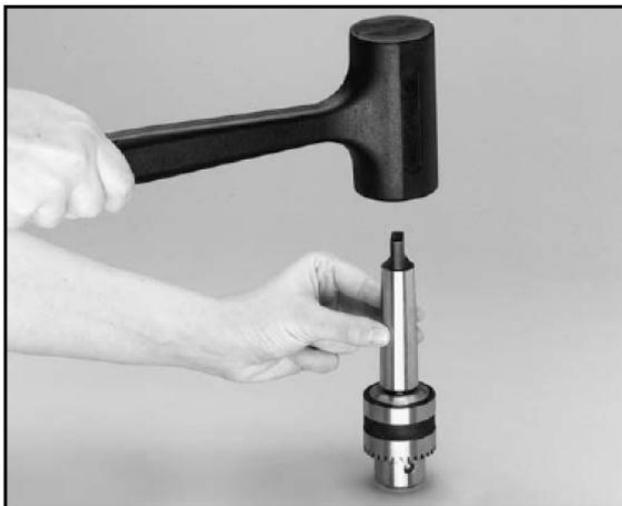
Upínací kužely sklíčidla a stroje musí být očištěny od konzervace a všech nečistot. K dobrému spojení musí být čisté a suché. Kličkou otevřete kleštiny sklíčidla tak, aby byly úplně zasunuté do těla sklíčidla. Položte hlavičku jako na obrázku, zasuňte do ní shora upínací kužel a dřevěnou nebo gumovou paličkou citlivě poklepejte. Nyní zasuňte upínací kužel do vřetene vrtačky a pomalu otáčejte, až zapadne. Nyní lehce paličkou na sklíčidlo poklepejte.
