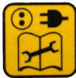
**DE** Vor Wartungsarbeiten muss die Maschine von der Stromquelle getrennt werden.
